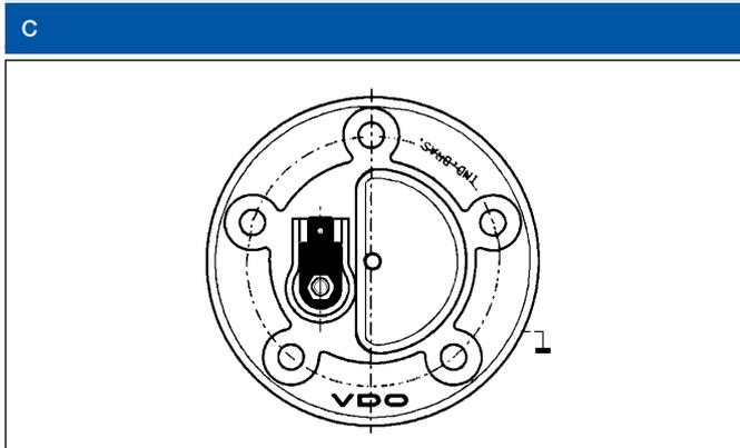
BLADE TERMINAL FOR OUTPUT, NO GROUND CONNECTION
